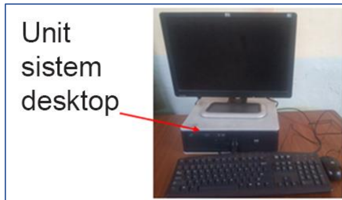
Gambar 3: Unit sistem desktop pada umumnya
